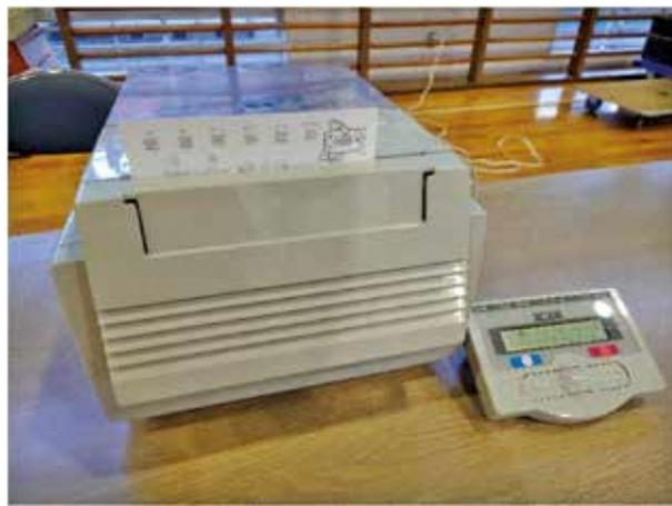
名前のおり、投票をしに来た人へ投票用紙を渡すための機械だよ。投票用紙を確実に1人1枚ずつ渡せるようになってきているんだ。
