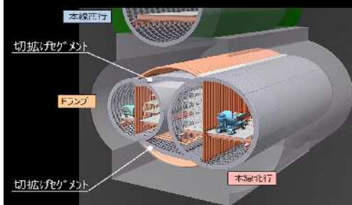
【ステップ⑤】 切掘げセグメント設置工・背面充填工
