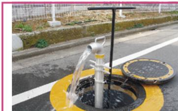
消火栓に差し込み、ホースを結合することで毎分100リットル以上の放水ができる消火用機材で、軽量で、かつ操作が容易です
