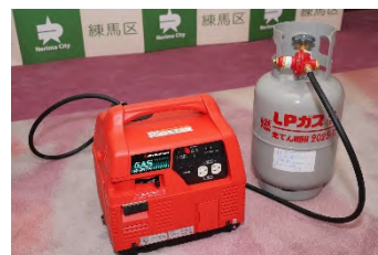
▲L P ガス 発電機
