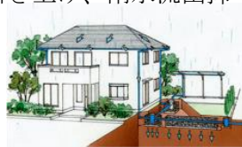
▲雨水貯留浸透施設設置例
