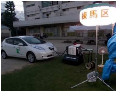
EVによる給電の様子
