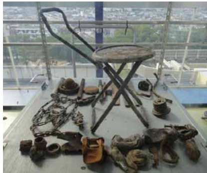
焼却炉の中から取り出された焼却不適物 パイプ、チェーンなど (葛飾清掃工場)
