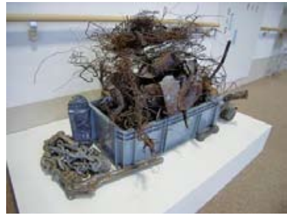
焼却炉の中から取り出された焼却不適物 針金ハンガー、傘、やかんなど (世田谷清掃工場)
