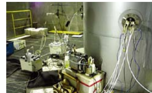
排ガスの採取状況
