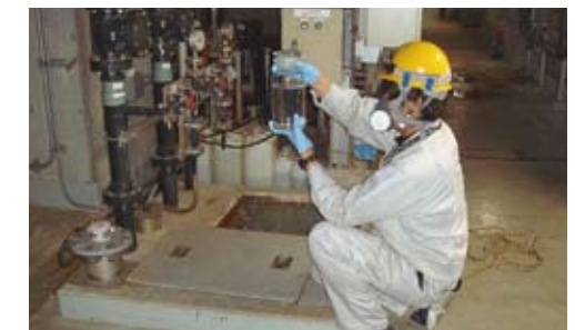
排水採取の様子（板橋清掃工場）
