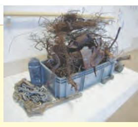
焼却炉の中から取り出された焼却不適物（世田谷清掃工場）
