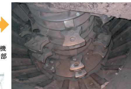
選別作業を終えた粗大ごみを一辺の長さ15cm以下に破碎します。途中、磁選機で鉄分を選別し回収します。
