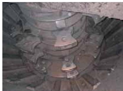
回転式破碎機(縦軸)の内部
