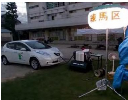
EVによる給電の様子
