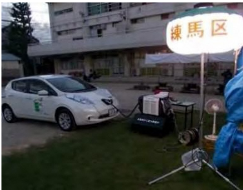
EVによる給電の様子
