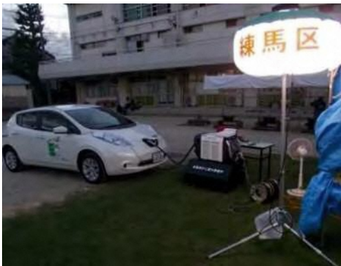
EVによる給電の様子
