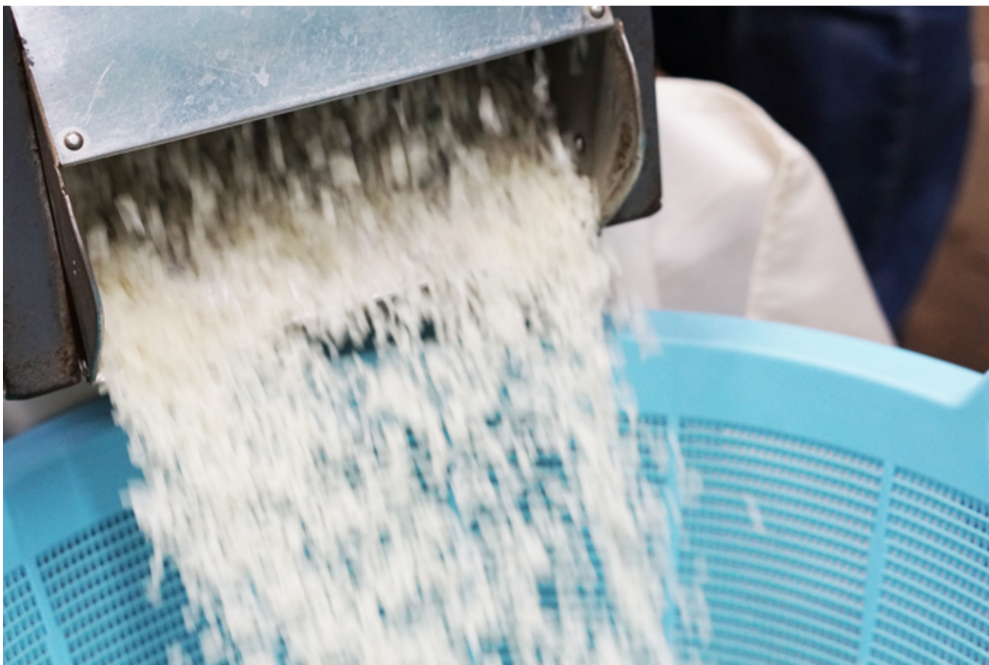
この機械を通すことでお米がパラパラとほぐされます
