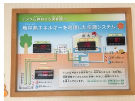
地中熱を利用した空調設備の仕組みと 利用状況を紹介するパネル
